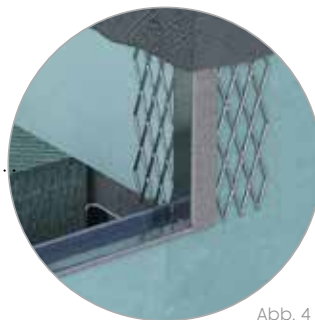
Einbau bei Betonparapet mit Trockenbauvorsatzschale
